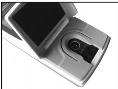
Insérez la bandelette de test dans la zone de test optique sous le support de bandelette, comme montré ci-dessous.
