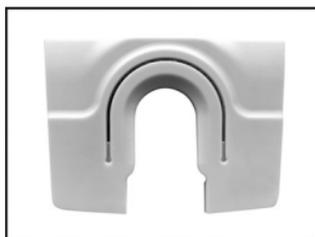
Pour retirer le support de bandelette, éloignez le support de bandelette de la fenêtre optique, en le glissant hors des rainures du support de bandelette vers le bas du compteur. En cas de présence de sang ou de débris, nettoyez le support de bandelette à l'aide des lingettes ultra désinfectantes DisCide, comme indiqué précédemment.
