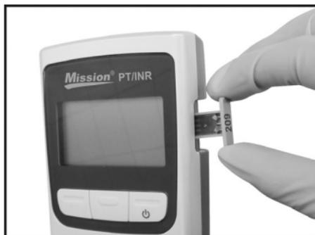
**Remarque:** Lors de l'insertion de la bandelette de test, assurez-vous que le code imprimé sur la puce de calibration est le même que celui imprimé sur la boîte de bandelettes de test et le même que celui indiqué sur l'écran de test du compteur.
