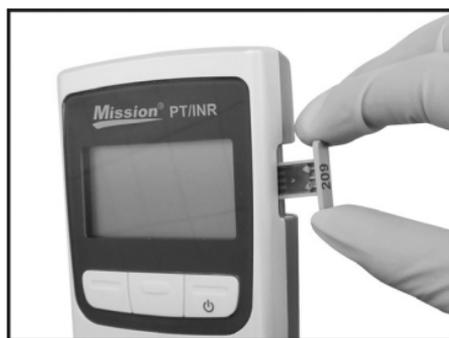
**Remarque:** Assurez-vous que le code de la puce de calibration est le même que celui imprimé sur la boîte de bandelettes de test et pochette de bandelette de test, et le même que celui indiqué sur l'écran de test du compteur lors de l'insertion d'une bandelette de test.
