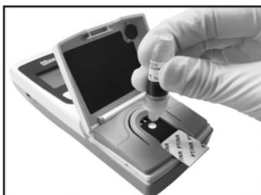
Fermez la fenêtre optique quand demandé par le compteur. Le compteur va continuer d'afficher le message pendant quelques secondes après la fermeture de la fenêtre optique. L'écran de chronométrage du test s'affiche ensuite, indiquant depuis combien de temps le test a commencé. Ne pas ouvrir la fenêtre optique tant que le test n'est pas terminé.
